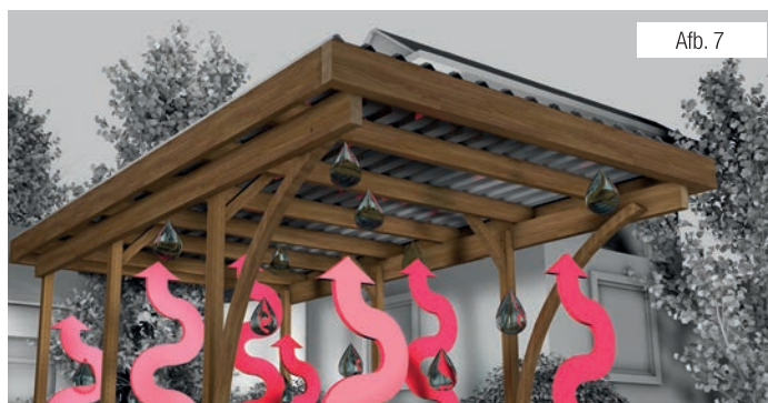
Vochtige lucht stijgt omhoog en vormt onder de profielplaten condens dat bij onvoldoende ventilatie gaat druppelen. Om druppelvorming te reduceren is een goede luchtcirculatie essentieel.
